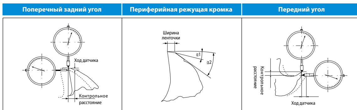
Рис. 6. Установка индикатора для проверки
